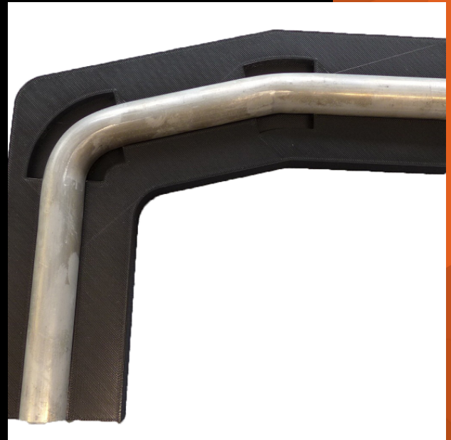
Przymiar używany do kontroli wymiarowej giętych elementów w firmie Meyra
